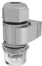
Sensor SKS-200 es externo y se conecta a terminales T1. Sensor es posible montar a panel (a través de cubierta transparente atornillable) a un agujero con diámetro de 20 mm. Parte del sensor es un soporte, con qué se puede colocar el sensor a pared. Longitud del cable a sensor no puede ser más que 50 mts. Como conductor se puede usar cable de dos hilos con diámetro min. 0.2 - 0.75 mm<sup>2</sup> / con manguera: 0.25 - 0.34 mm<sup>2</sup>. Protección de sensor es IP65.
