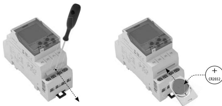
Reemplazo de la batería se puede realizar sin necesidad de retirar el dispositivo.
