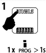
Press of programming button on actuator (e.g. RFSAI-61B-SL) for 1 second will activate actuator into programming mode. LED is flashing in 1s interval. Pulsando el botón de programación de la unidad por ejemplo RFSAI-61B-SL durante más de 1 segundo, entra al modo de la programación. LED parpadea en intervalo de 1 segundo.
