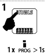
Press of programming button on actuator (e.g. RFSAI-61B-SL) for 1 second will activate actuator into programming mode. LED is flashing in 1s interval. Stiskem programovacího tlačítka na spínací prvku (např. RFSAI-61B-SL) na dobu 1 vteřiny se uvede prvek do programovacího režimu. LED bliká v intervalu 1 vteřiny.
