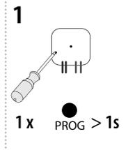
Press of programming button on receiver RFSAI-61B for 1 second will activate receiver RFSAI-61B into programming mode. LED is flashing in 1s interval. Pulsando el botón de programación de la unidad RFSAI-61B durante más de 1 segundo, entra al modo de la programación. LED parpadea en intervalo de 1 segundo.
