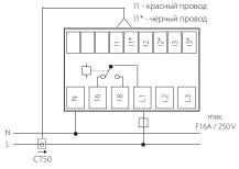
Прим.: стрелка внутри трансформатора тока СТ50 должна быть направлена на электроприбор.
