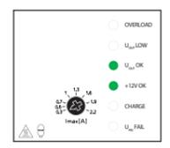
Das Schaltnetzteil arbeitet nicht - Pufferbetrieb
