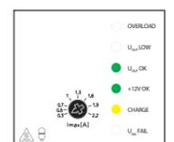
Das Schaltnetzteil arbeitet nicht - Pufferbetrieb.
