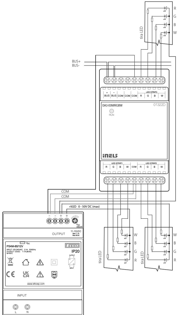
\*Para conectar las tiras LED utilice siempre la sección adecuada de los conductores de conexión correspondiente al consumo de las tiras LED. Para cada tira LED utilice su propia brida COM más cercana y minimalice los bucles de corriente de los conductores.
