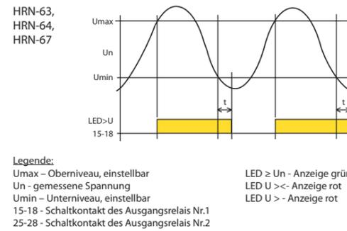
Überwachungsrelais HRN-3 dient zur Überwachung des Spannungsniveau in 1-Phasen-Netzen. Die überwachte Spannung ist gleichzeitig auch die Versorgungsspannung.
