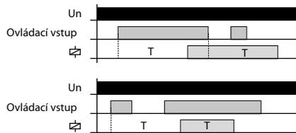
Po přivedení napájecího napětí je relé rozeznuto. Je-li sepnut ovládací kontakt, začne časové zpoždění T. Po ukončení časování relé sepne. Rozpojením ovládacího kontaktu začne nové časové zpoždění T. Po ukončení časování relé rozezne. Je-li ovládací kontakt rozpojen během časování, po ukončení časování relé sepne a po uplynutí nového časového zpoždění T relé rozezne. Další změna stavu ovládacího kontaktu v průběhu časování je ignorována.
