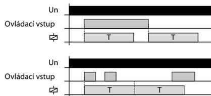
Po přivedení napájecího napětí je relé sepnuto. Je-li sepnut ovládací kontakt, relé sepne a začíná časové zpoždění T. Po ukončení časování relé rozezne. Rozpojením ovládacího kontaktu relé znovu sepne a začíná časové zpoždění T. Po ukončení časování relé rozezne. Je-li ovládací kontakt rozpojen během časování, relé zůstane sepnuto po dobu 2T. Po ukončení časování relé rozezne. Další změna stavu ovládacího kontaktu v průběhu časování je ignorována.
